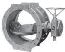
Przepustnice kołnierzowe podwójnie mimośrodowe nr 4493 (4497 K F4), korpus i dysk GGG50, z przekładnią ręczną, pierścień mocujący uszczelkę ze stali
